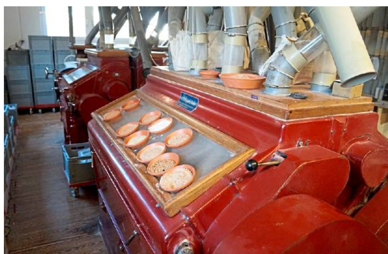
Walzenmühle mit unterschiedlich bearbeitetem Getreide.
